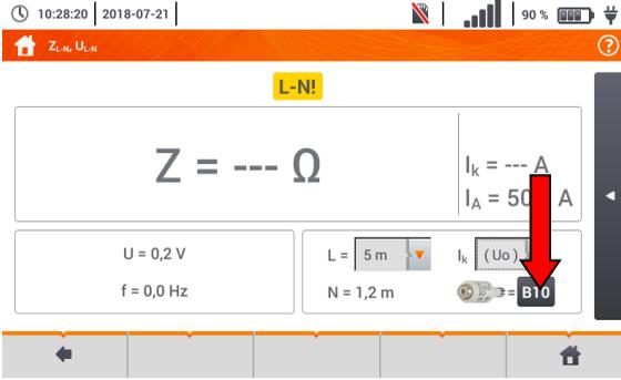
Das Ergebnis kann mit der zulässigen Impedanz  $Z_{sdp}$  verglichen werden, bestimmt auf der Basis der Sicherungsparameter:
