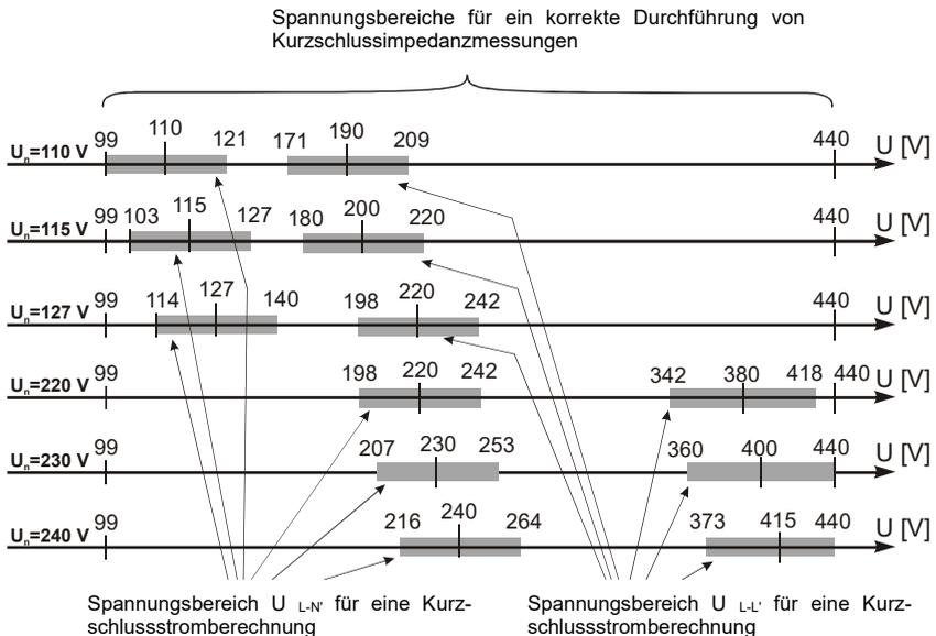
**Fig. 3.6 Messspannungsbereiche**
