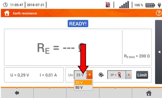
Wählen Sie die Messspannung  $U_n$  über das folgende Menü.
