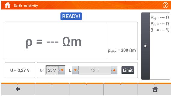
$R_H$  – Widerstand der Stromelektrode
