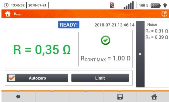
**R<sub>F</sub>** – Ergebnis erzielt durch **positive** Messstrom
