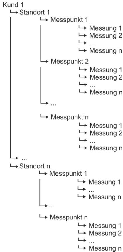
**Fig. 5.1. Struktur des Gerätespeichers für einen Kunden**
