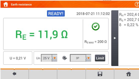
$R_H$  – Widerstand der Stromelektrode
