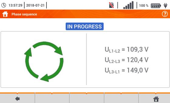
Phasensequenz **richtig**, im Uhrzeigersinn
