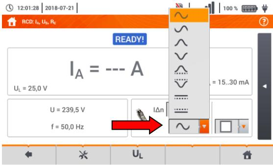
Bestimmen Sie die Wellenform des Prüfstromes und wählen diesen aus dem folgenden Menü aus.
