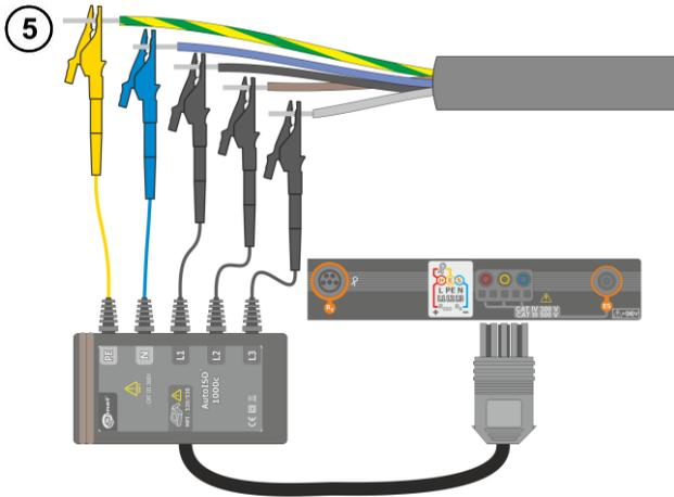
Verbinden sie den AutoISO-1000c Adapter an dem zu testenden Kabel.
