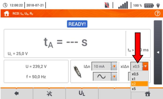
Ist der RCD  $t_A$  Modus in Schritt ① ausgewählt, wählen Sie den Faktor des Auslösestromes.
