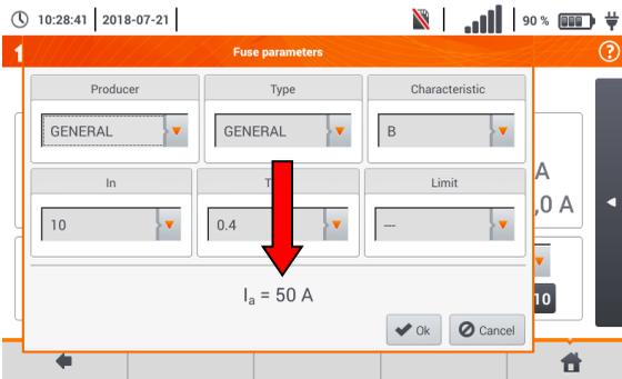
Der Strom wird nach dem Einstellen der Parameter in Schritt (6) (7) berechnet.
