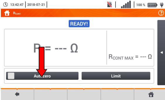
Um das Messergebnis nicht durch den Widerstand der Messleitungen zu beeinflussen, für Sie die **Autozero** Prozedur durch
