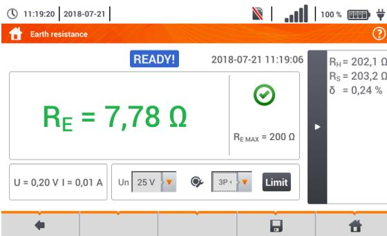
**R<sub>H</sub>** – Widerstand der Stromelektrode
