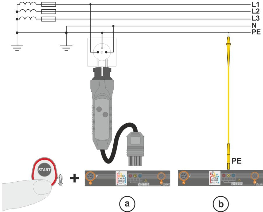
Ist das Prüfgerät wie oben in der Abbildung dargestellt angeschlossen, berühren Sie die Kontaktelektrode und warten Sie ca. **1 Sekunde**. Wird Spannung am PE-Leiter erkannt:
