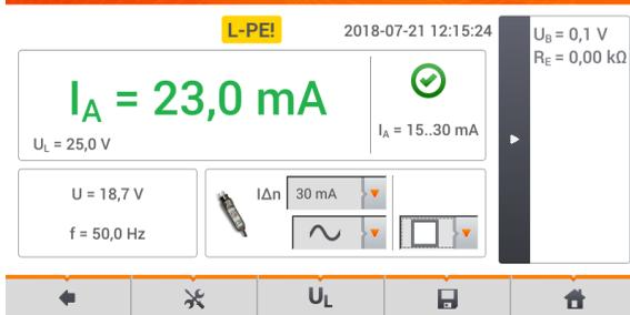
**U<sub>B</sub>** – Spannungsmessung gegen PE
