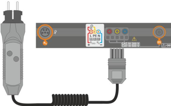
Verbinden Sie den **WS-03 Adapter** oder **WS-04 Adapter** mit dem UNI-Schuko Stecker
