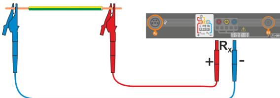
• Verbinden sie die Messleitungen mit dem zu messenden Objekt
