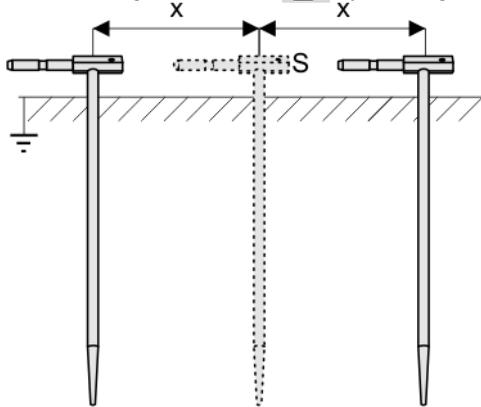
Wiederholen Sie die Schritte **(2)(5)(6)** an zwei verschiedenen Positionen der Spannungselektrode **S**:
